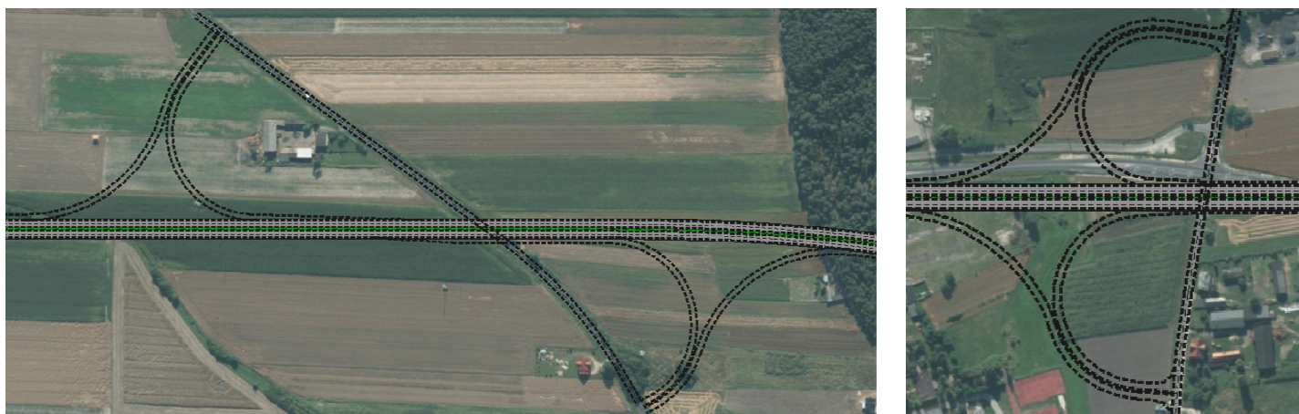
Przykładowe rozwiązanie skrzyżowań dwupoziomowych na szlaku projektowanej drogi krajowej nr 25
