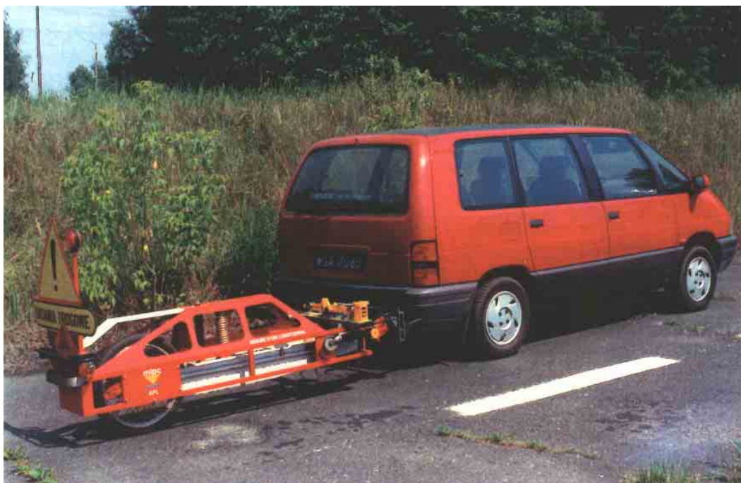
Fot. Przykład urządzenia pomiarowego (Zestaw APL)
