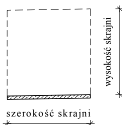
Rys. 17. Schemat skrajni chodnika na obiekcie mostowym.
