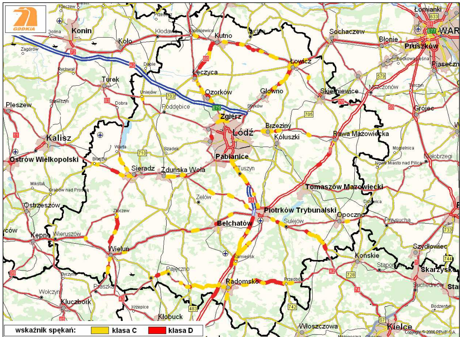
Rysunek 23. Lokalizacja odcinków dróg ze wskaźnikami stanu spękań (klasa C i D) na terenie Oddziału w Łodzi
