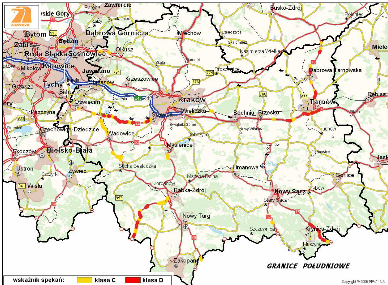
Rysunek 22. Lokalizacja odcinków dróg ze wskaźnikami stanu spękań (klasa C i D) na terenie Oddziału w Krakowie
