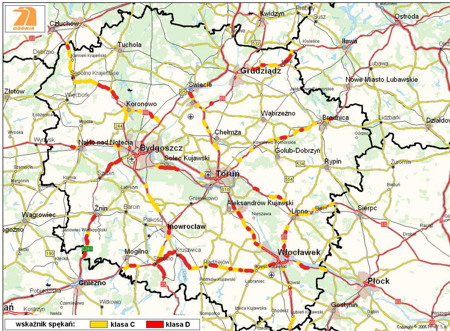
Rysunek 18. Lokalizacja odcinków dróg ze wskaźnikami stanu spękań (klasa C i D) na terenie Oddziału w Bydgoszczy
