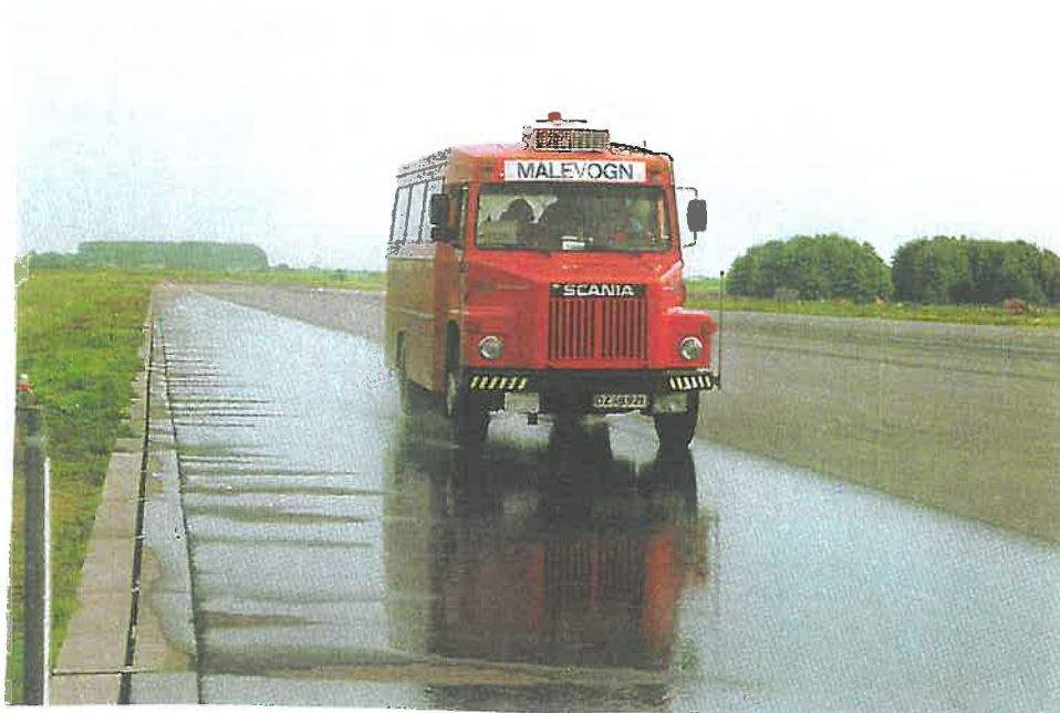
Duńskie urządzenie Stradograph. Pod autobusem znajdują się dwa koła pomiarowe, swobodnie toczone, odchyłone od kierunku ruchu o kąt 12^{\circ}
