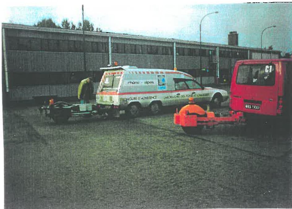
Urządzenie francuskie Adhera (w głębi). Na planie pierwszym polski zestaw pomiarowy SRT-3. Oba urządzenia pracują wg tej samej zasady (pełna blokada koła pomiarowego)
