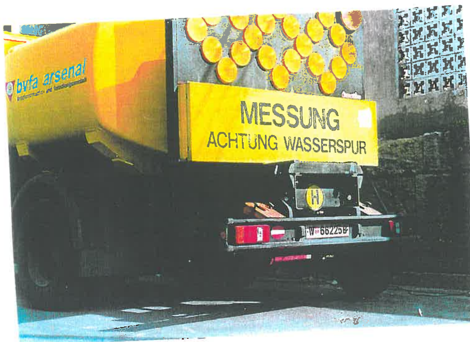
W jednej z opcji sterowania koło pomiarowe hamowane jest z użyciem pulsatora (regulatora) typu ABS. Możliwość pomiaru maksymalnej wartości wsp. przyczepności
