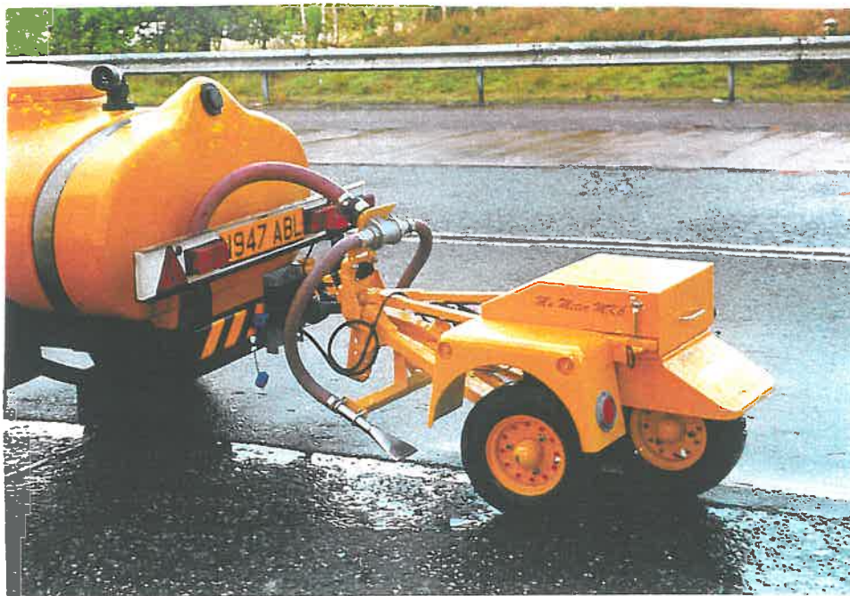
Urządzenie pomiarowe Mu – Meter z dwoma kołami wleczonymi skośnie (swobodnie) względem kierunku ruchu
