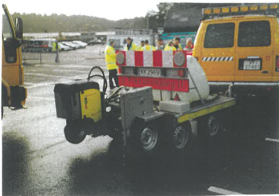
Urządzenie pomiarowe Norsemeter ROAR, zabudowane na specjalnej 4-kołowej przyczepce (ze zbiornikiem wody). Obok – po prawej stronie - SALTAR
