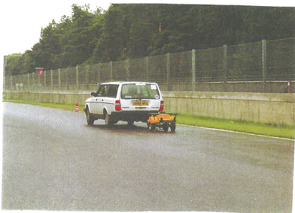
Urządzenie pomiarowe Griptester. Zasada działania: - koło pomiarowe napędzane z poślizgiem 20 % od kół nośnych za pomocą przekładni łańcuchowej
