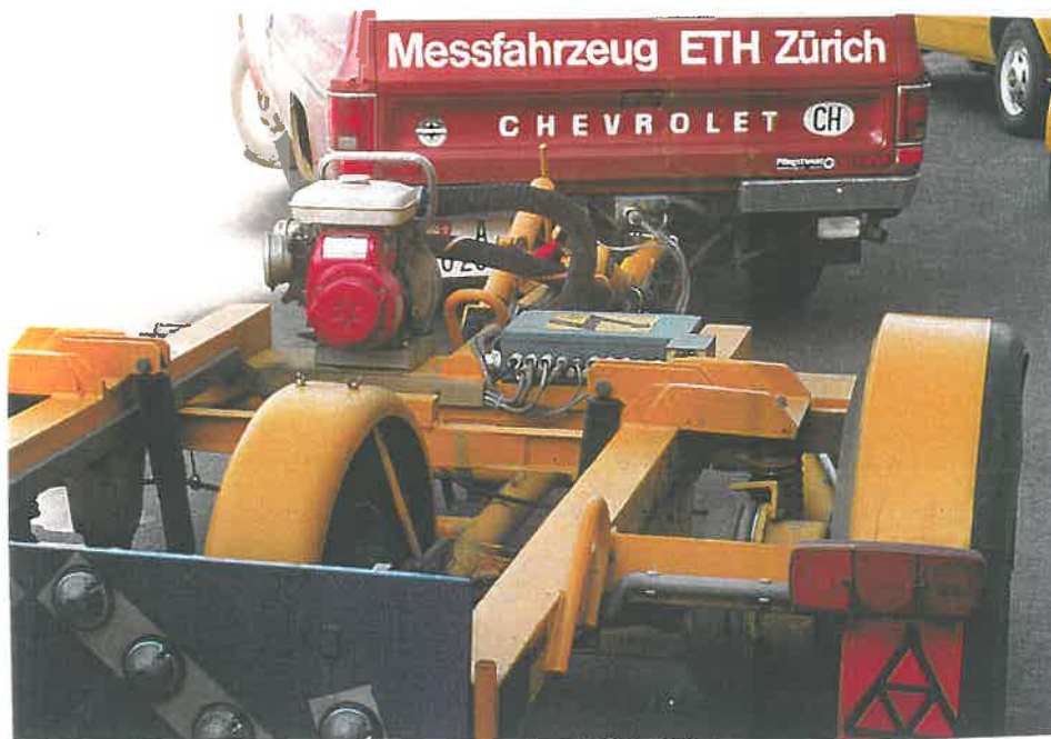
Skiddometer BV – 8. Możliwość pomiaru współczynnika przyczepności w warunkach pełnej blokady koła pomiarowego i przy poślizgu względnym 20 %
