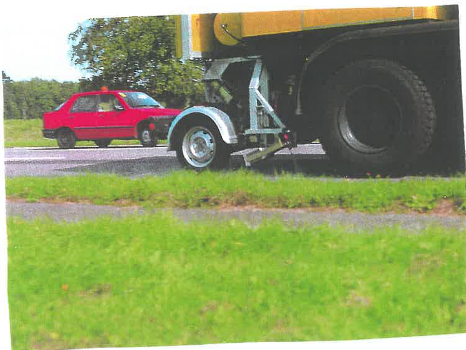
Stuttgarter Reibungsmesser – koło pomiarowe napędzane od specjalnej skrzyni przekładniowej. Możliwość pomiaru przy poślizgu 100 % i 20 %
