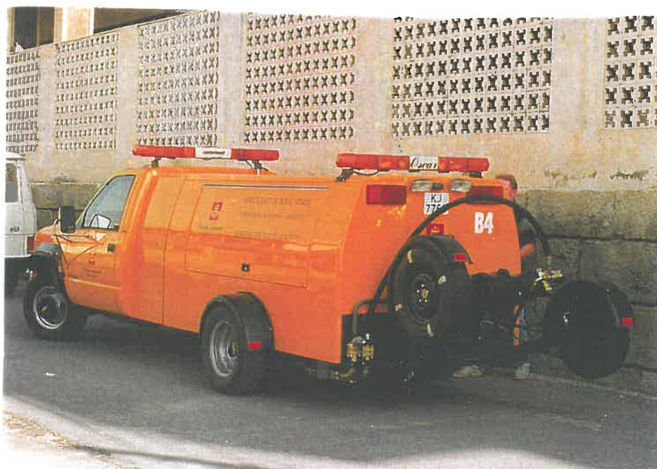
Urządzenie pomiarowe Norsemeter OSKAR. Jedno z kół pomiarowych umożliwia hamowanie do pełnej blokady, drugie - hamowanie z kontrolowanym poślizgiem
