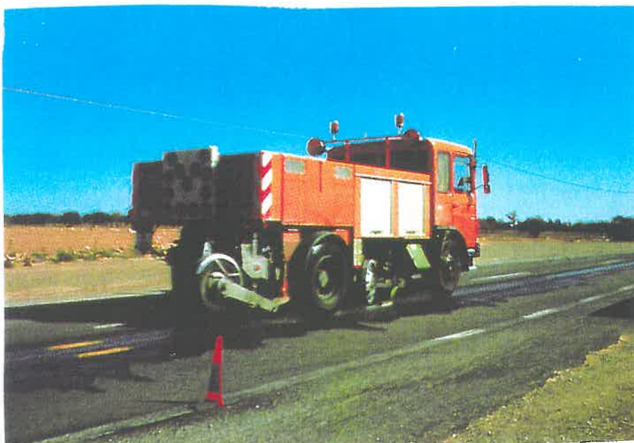
Duńskie urządzenie Stradograph. Pod autobusem znajdują się dwa koła pomiarowe, swobodnie toczone, odchyłone od kierunku ruchu o kąt 12^{\circ}
