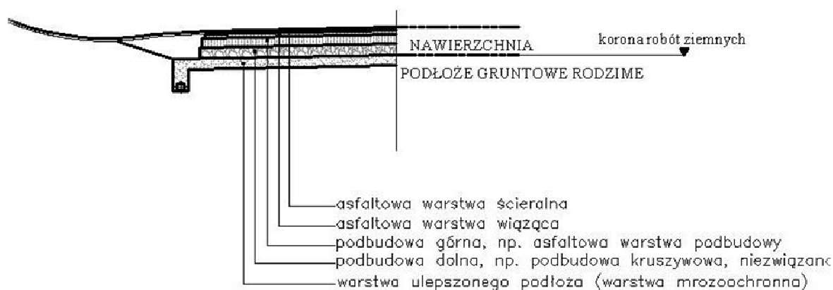
Rysunek 1. Konstrukcja asfaltowej nawierzchni drogowej w wykopie
