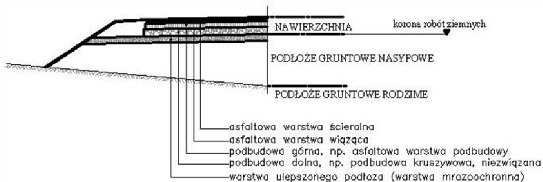
Rysunek 2. Konstrukcja asfaltowej nawierzchni drogowej w nasypie
