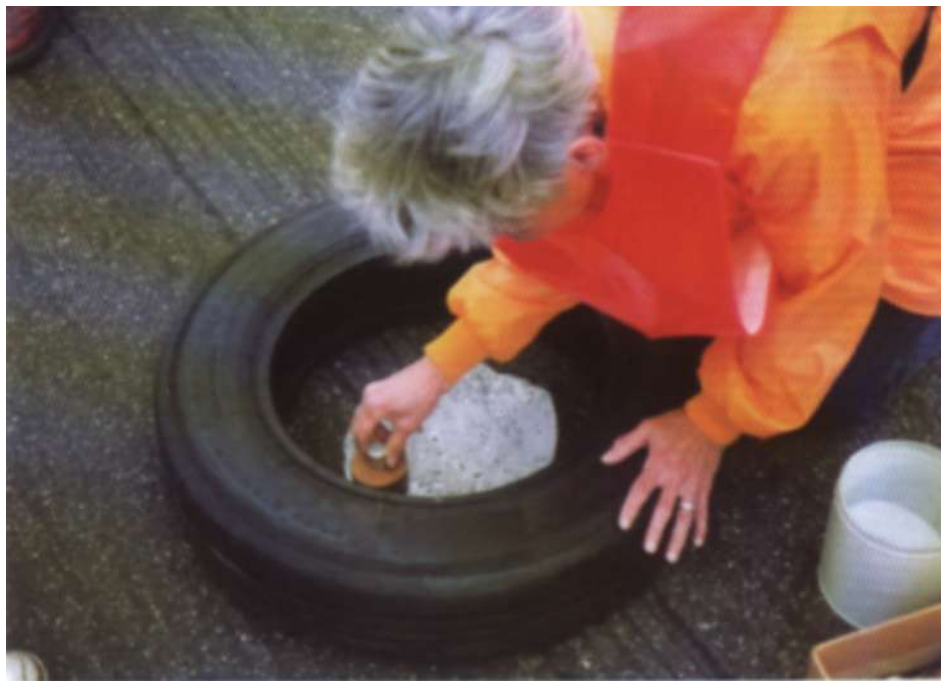
Foto 13 Badanie makrotekstury nawierzchni metodą objętościową
