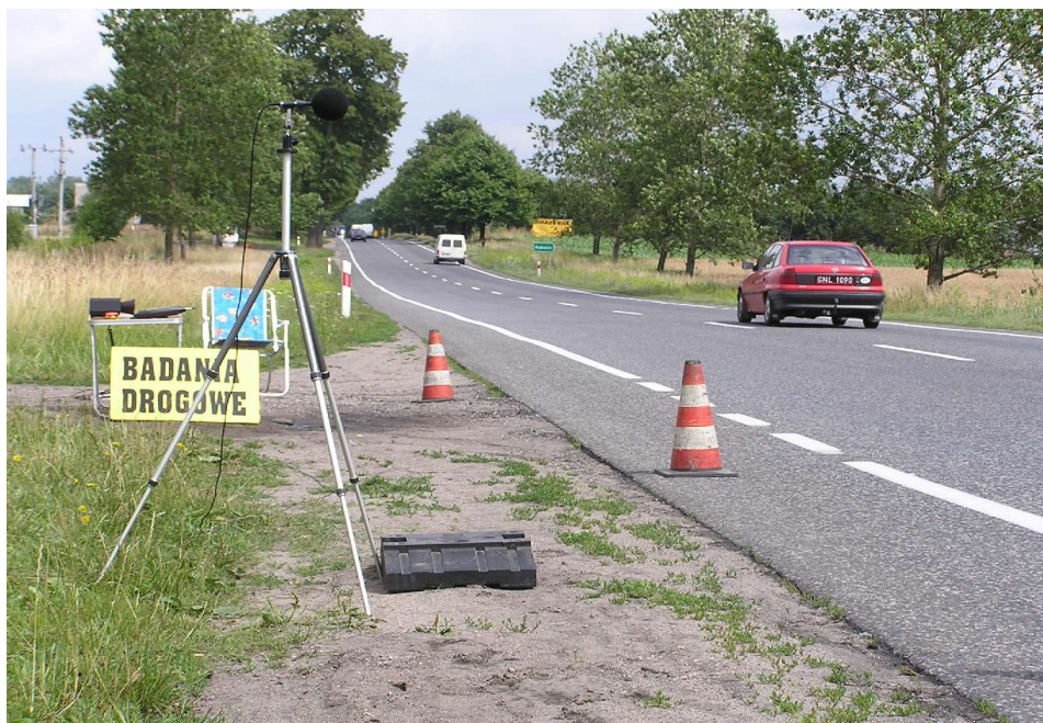
Foto 3 Widok stanowiska badawczego przy pomiarach metodą SPB
