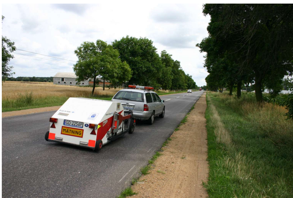
Foto 8 Przejazd przyczepki pomiarowej po wytypowanym odcinku
