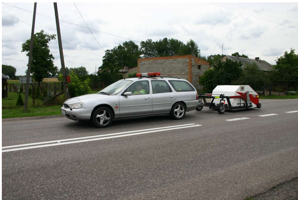
Foto 7 Przejazd przyczepki pomiarowej po wytypowanym odcinku
