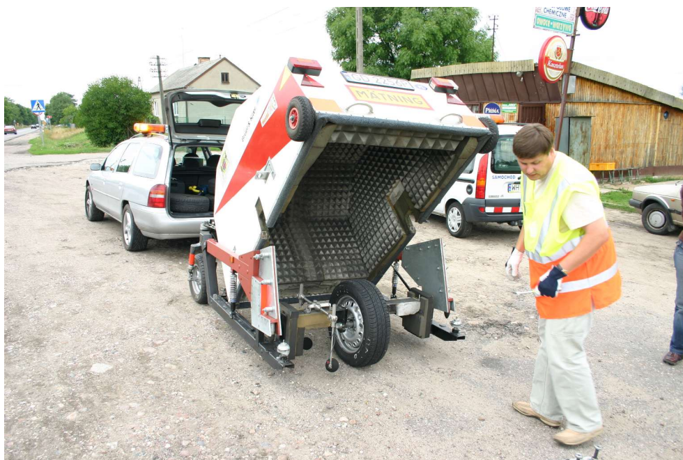
Foto 9 Widok przyczepki badawczej w trakcie wymiany opony
