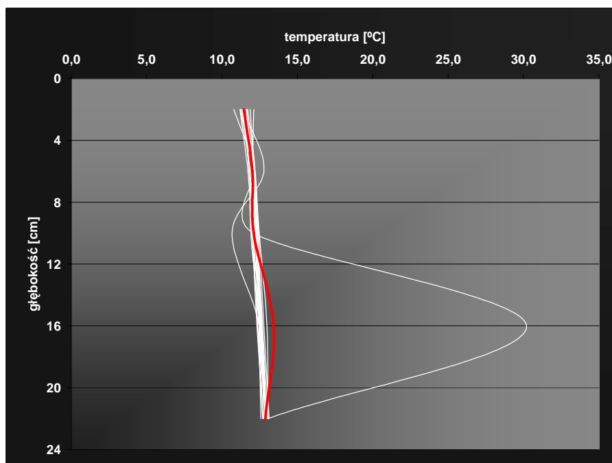
Rysunek 4.14 Średnie profile temperatury zarejestrowanej na wszystkich próbkach w październiku (kolorem czerwonym oznaczono średni profil miesięczny)
