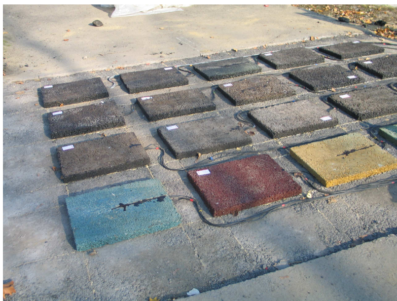
Rysunek 3.16 Rozmieszczenie płyt warstw ścieranych
