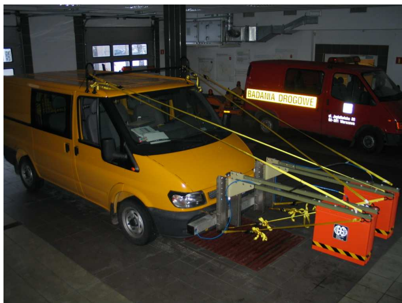
Rysunek 5 Samochód pomiarowy z zainstalowanymi antenami 1,0 i 2,2 GHz
