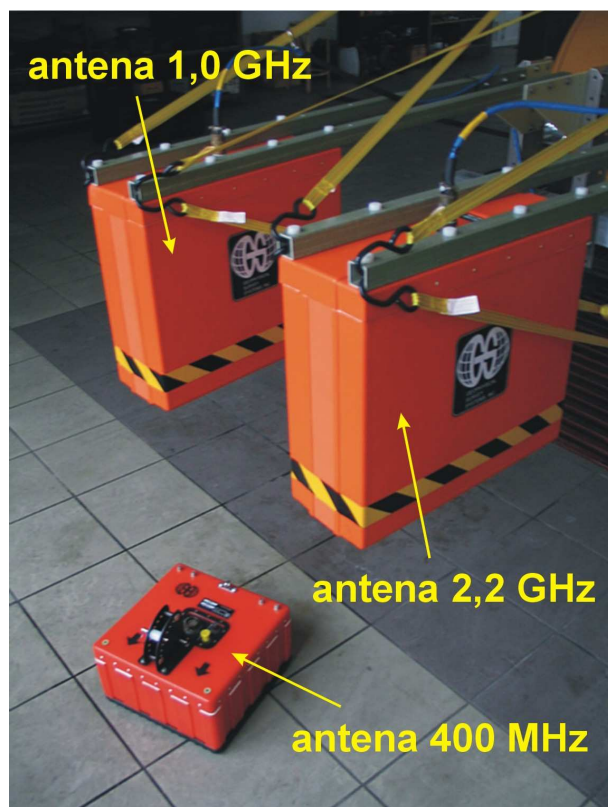
Rysunek 4 Anteny o częstotliwościach 400MHz, 1,0 GHz i 2,2 GHz
