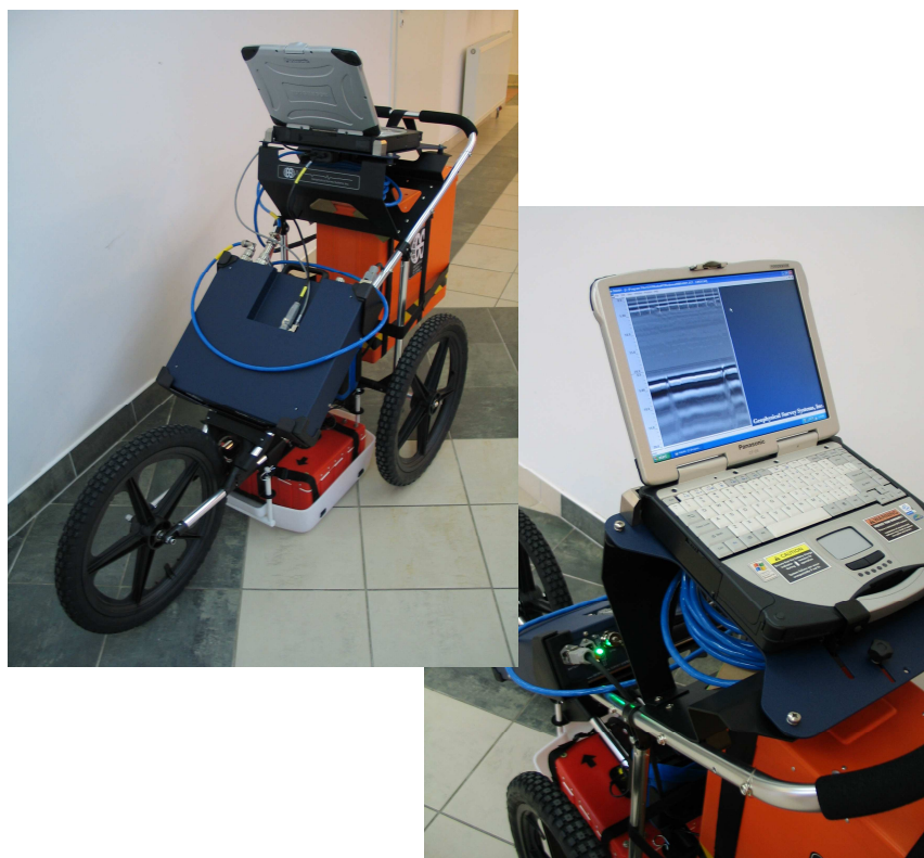
Rysunek 7 Wózek pomiarowy z antenami 400MHz i 2,2GHz
