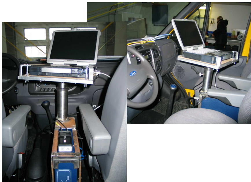
Rysunek 6 Zainstalowana w samochodzie jednostka centralna wraz z komputerem pomiarowym
