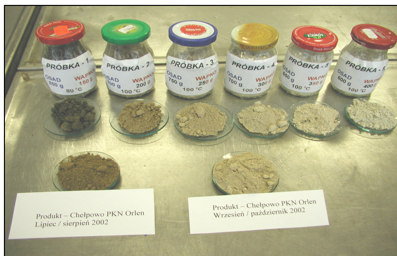
Rys. 2 - Przetworzone osady o różnej zawartości CaO wykonane w Laboratorium IBDiM dla porównywania z produktem uzyskiwanym w Płocku
