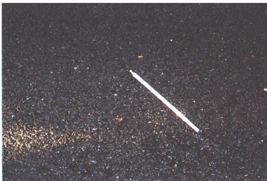
Fot 5. Mieszanka MNU 0/6 mm z granulatem gumowym 2/7 mm
