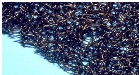
Fot. 23. Struktura geomaty przestrzennej zastosowanej na skarpach Terminalu w Olszynie [17]
