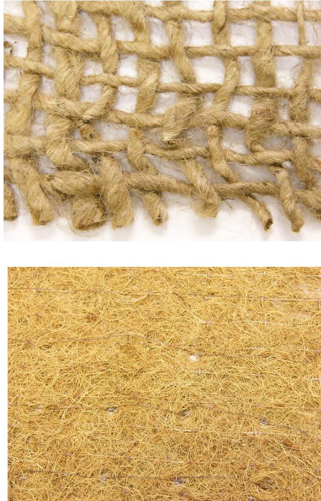
Rys. 6. Przykłady materiałów do ochrony przeciwozyjnej ulegających biodegradacji (fot. A. Krzyczkowska)
