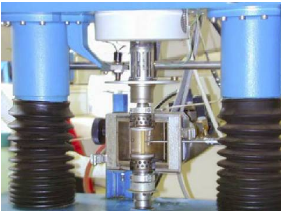
Rysunek 17. Aparat Metravib do badań reologicznych lepiszczy asfaltowych w LCPC
