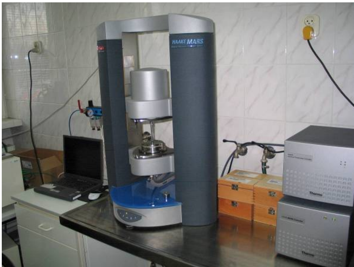
Fot. 5 Reometr dynamicznego ścinania DSR MARS Haake w laboratorium IBDiM
