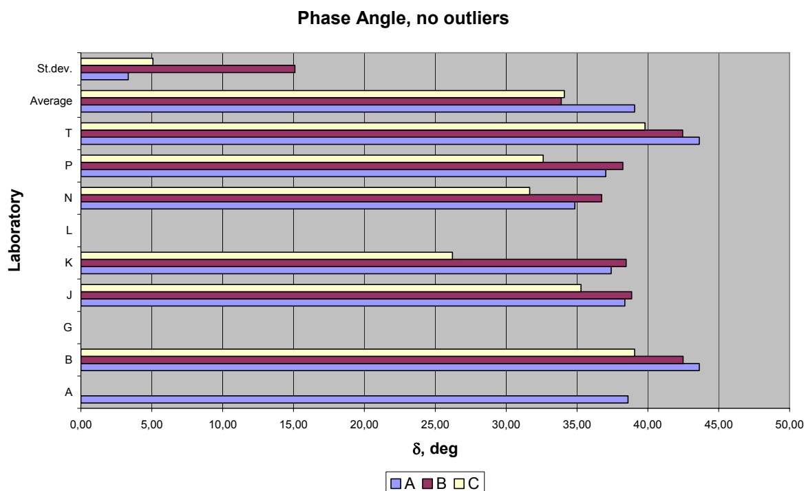
Rysunek 59. Kąt przesunięcia fazowego, bez wyników odchylonych
