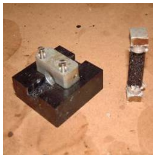
Rysunek 23. Przygotowanie próbek mieszanki piaskowo-asfaltowej do badania zmęczenia metodą skręcania
