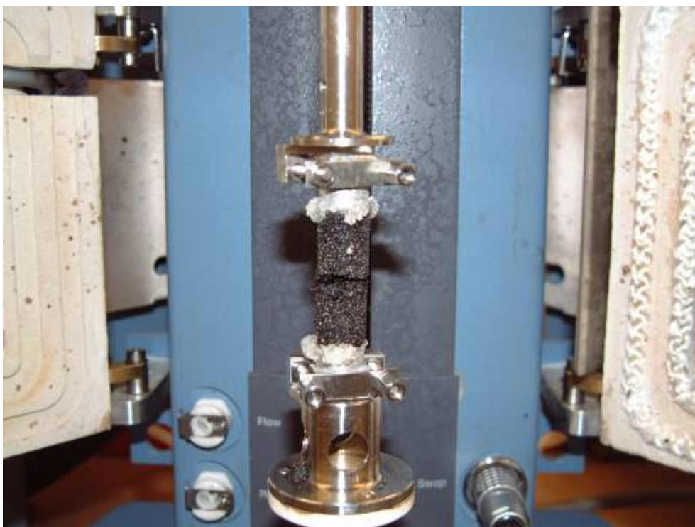
Rysunek 25. Zniszczona próbka po badaniu zmęczenia metodą skręcania
