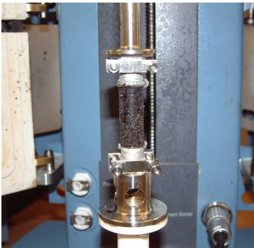
Rysunek 24. Badanie zmęczenia metodą skręcania
