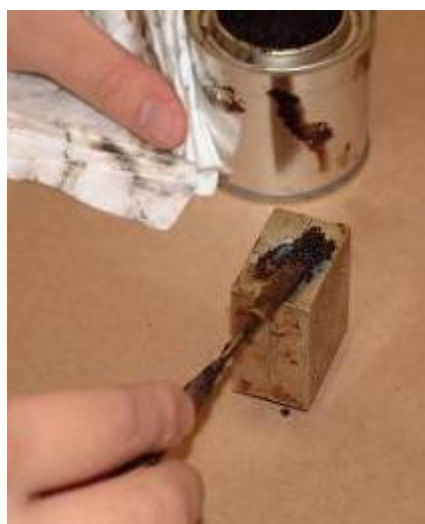
Rysunek 23. Przygotowanie próbek mieszanki piaskowo-asfaltowej do badania zmęczenia metodą skręcania
