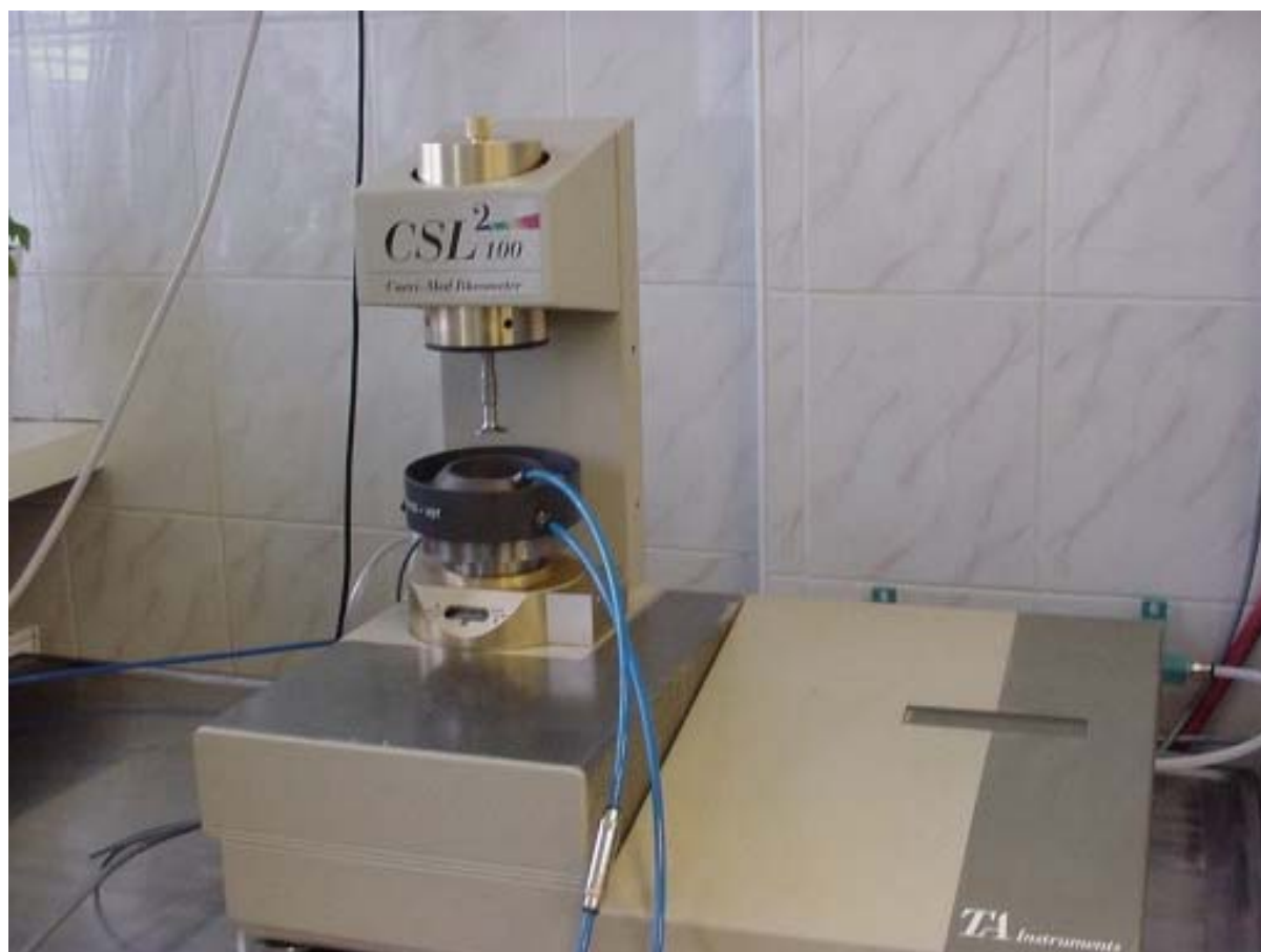
Fot. 4 Reometr dynamicznego ścinania DSR CarriMed TA Instruments w laboratorium IBDiM
