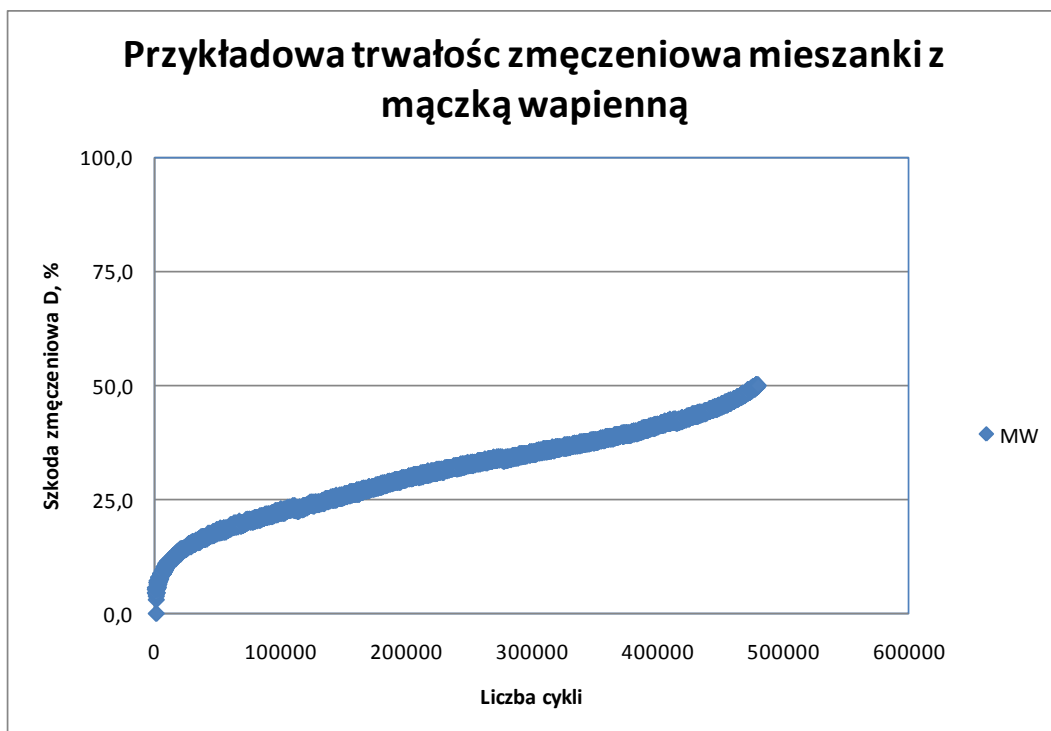
Rysunek 10. Przebieg badania zmęczenia próbek wykonanych z BA16
