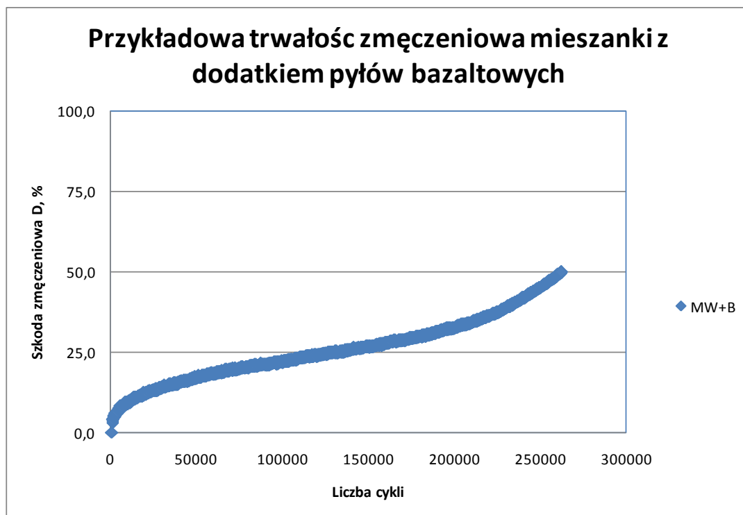
Rysunek 12. Przebieg badania zmęczenia próbek wykonanych z BA16
