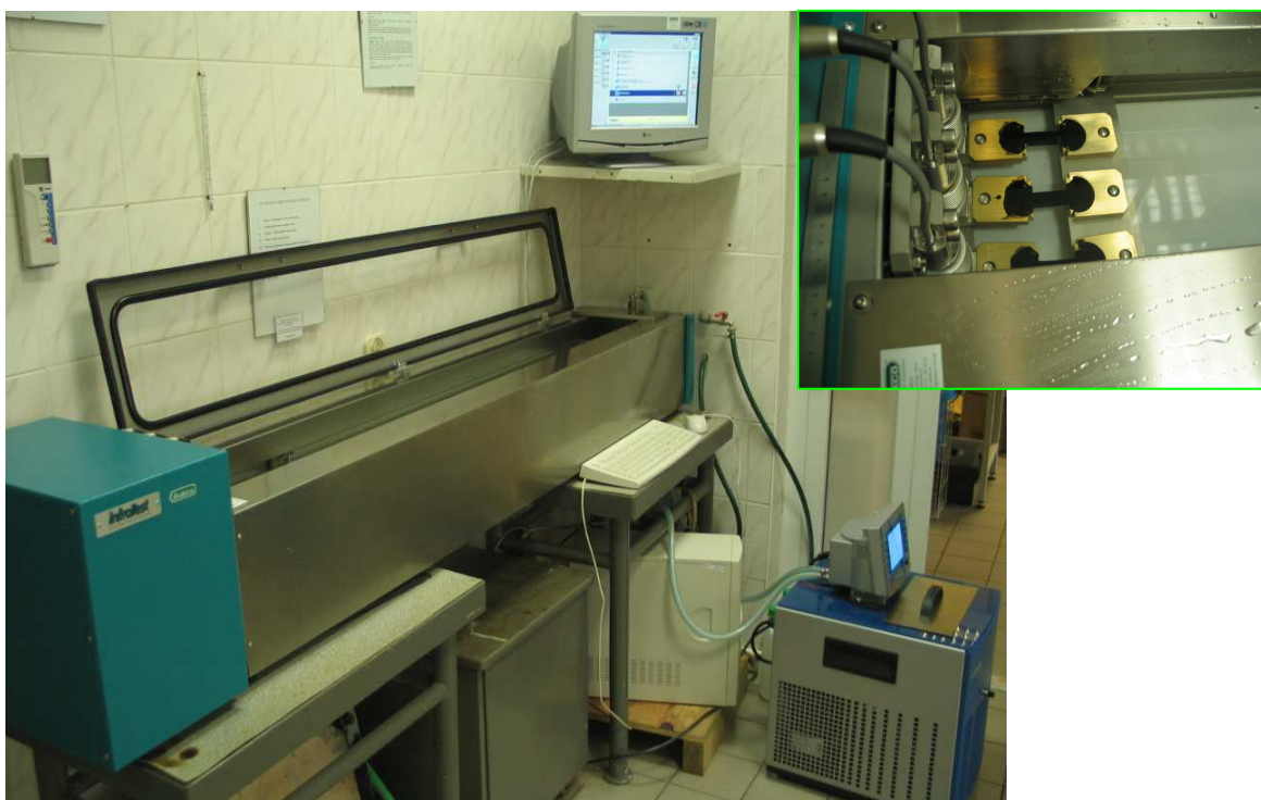
Fot. 1 Widok duktylometru oraz próbek do badań w łaźni wodnej
