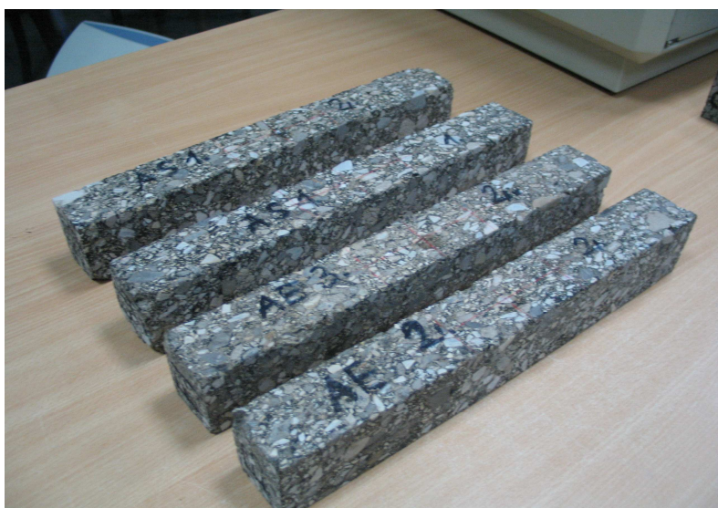
Rysunek 9 Belki z mieszanek MCE i MCAS przeznaczone do badań modułu sztywności oraz odporności na zmęczenie
