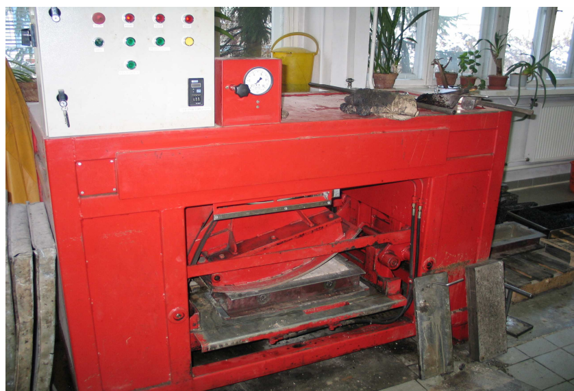
Rysunek 8 Zagęszczanie płyt MCE i MCAS
