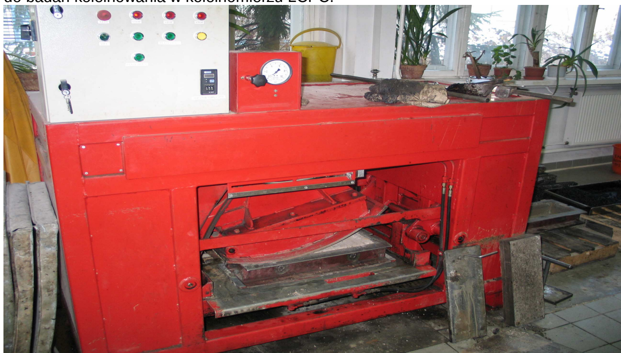
Rysunek 6 Zagęszczanie płyt MCE i MCAS
