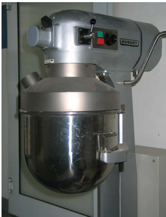
Rysunek 5 Mieszadło laboratoryjne HOBART o pojemności 20l
