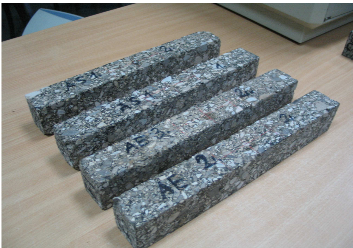
Rysunek 7 Belki z mieszanek MCE i MCAS przeznaczone do badań modułu sztywności oraz odporności na zmęczenie
