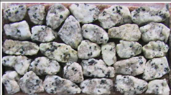
Próbka do badania PSV (90,6x44,5 mm)
