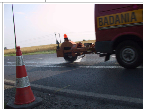
Pomiar współczynnika tarcia nawierzchni zestawem SRT-3
