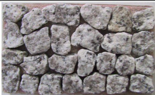
Próbka do badania AAV (92x54 mm)
