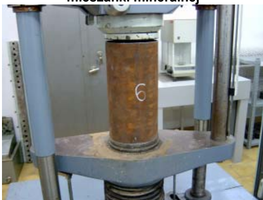
Rys. 6.9 Zagęszczanie prasą statyczną
