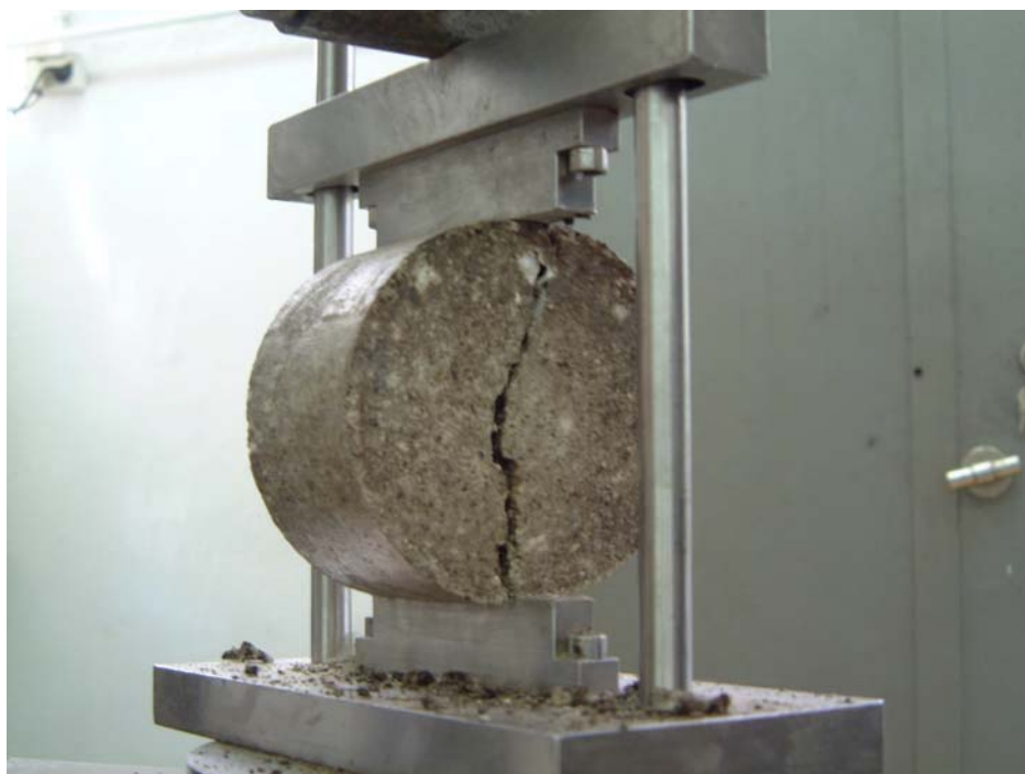
Rysunek 6.1. Badanie wytrzymałości mieszanki MCE na pośrednie rozciąganie
