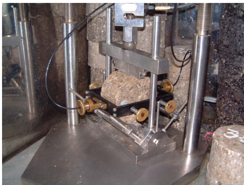
Rysunek 6.2. Badanie modułu sztywności mieszanki MCE w aparacie NAT
