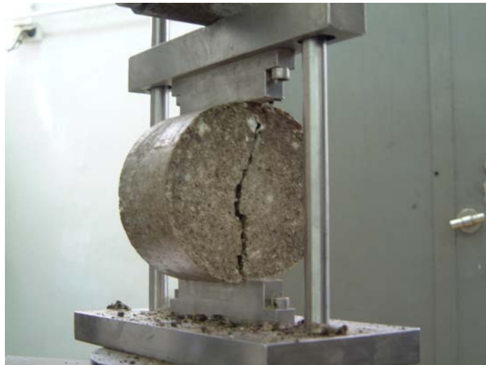
Rysunek Z.3. Badanie wytrzymałości mieszanki MCE na pośrednie rozciąganie, bez pomiaru przemieszczeń poziomych
