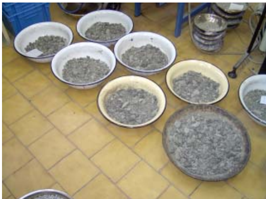
Rys. 6.7 Przygotowane suche zaroby mieszanki mineralnej
