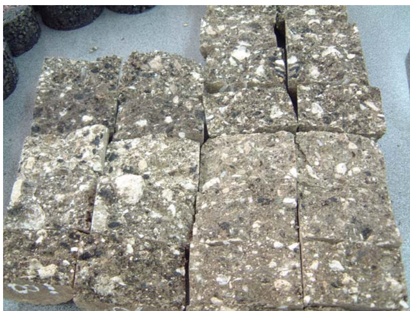
Rysunek. 6.40. Próbkki mieszanki MCE po badaniu pośredniego rozciągania
