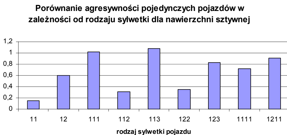
Rysunek 13. Agresywność poszczególnych sylwetek dla nawierzchni sztywnej wg AASHTO
