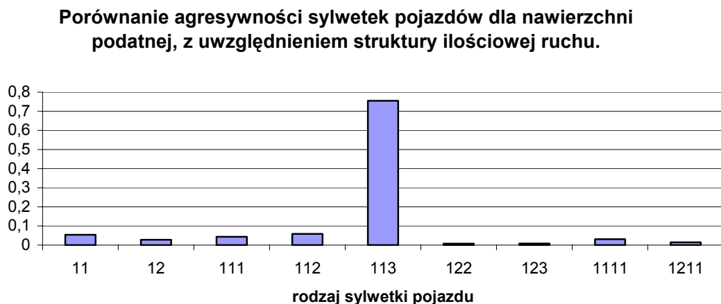
Rysunek 14. Agresywność poszczególnych sylwetek dla nawierzchni podanej wg AASHTO z uwzględnieniem ich ilości na drodze.
