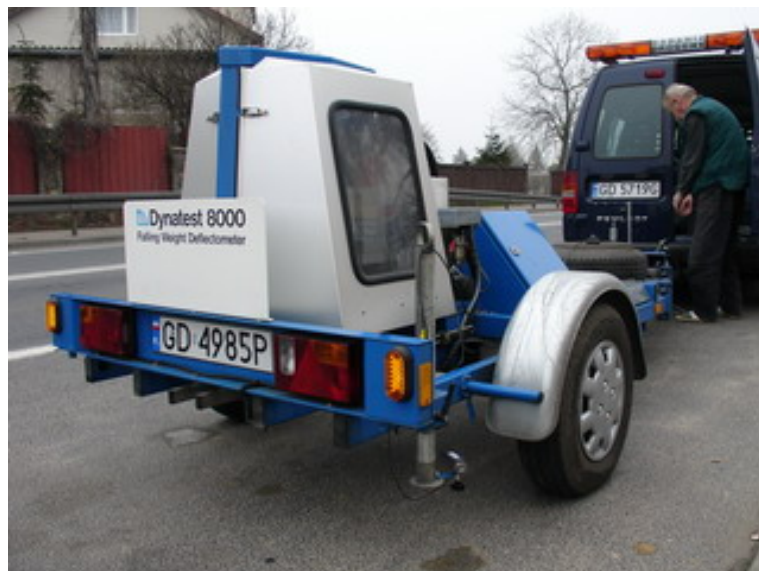
Rysunek 4.28. Widok ugięciomierza dynamicznego FWD
