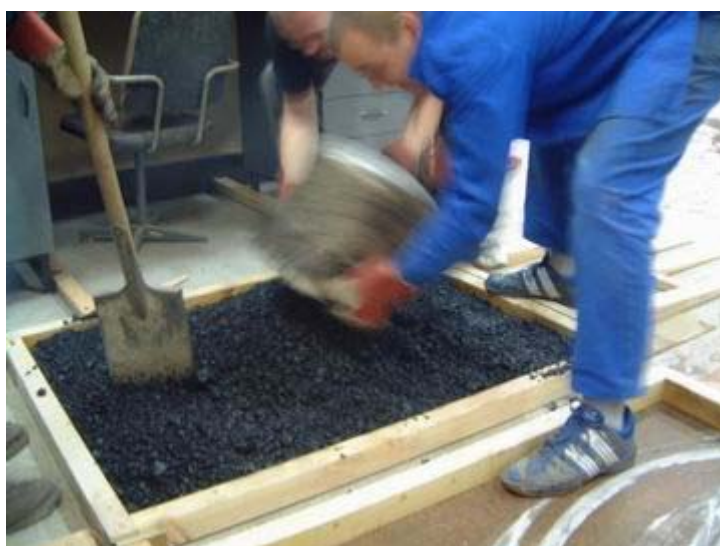
Rys.3.2. Wypełniania form betonem asfaltowym.
