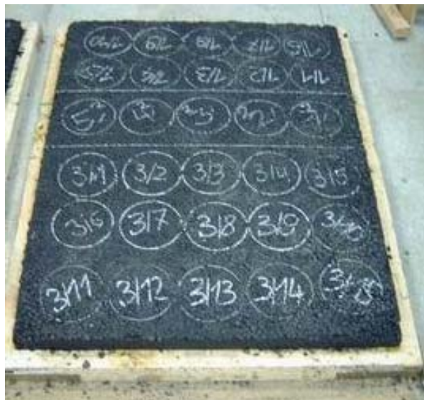
Rys.3.7. Widok płaszczyzn z oznaczonymi miejscami odwiertu i wyciętych próbek.
