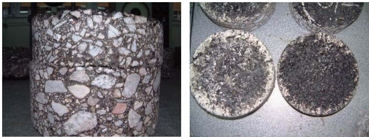
Rys. 3.13. Widok próbki i płaszczyzn międzywarstwowch po ścinaniu międzywarstwowym wg Leutnera.
