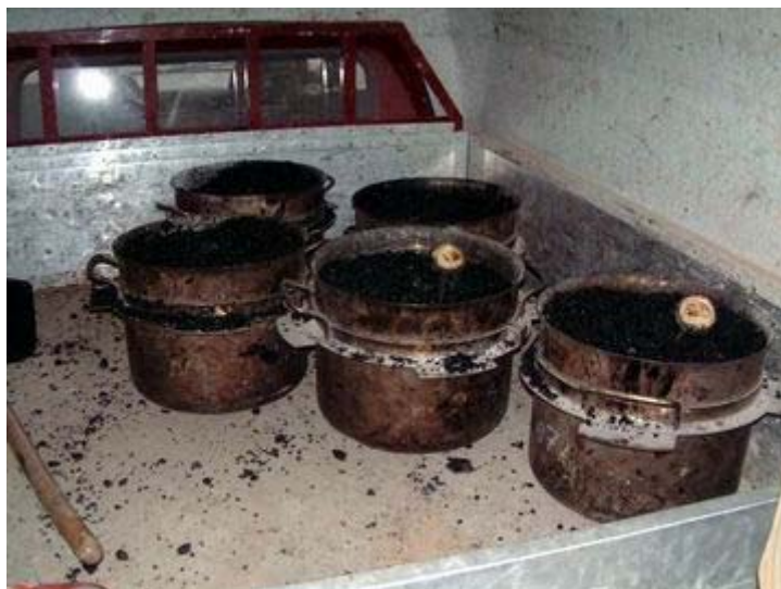
Rys. 3.1. Widok pojemników z betonem asfaltowym dowiezioną z WMMA
