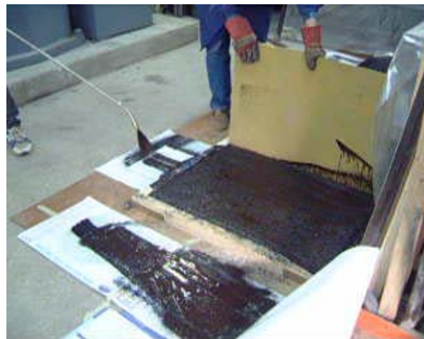
Rys. 3.10. Wykonanie warstwy szepnej. Natrysk emulsji asfaltowej.
