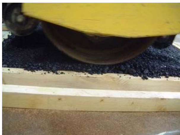
Rys. 3.3. Zagęszczanie betonu asfaltowego do warstwy wiążącej walcem stalowym.
