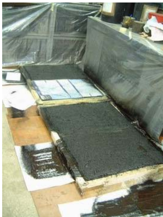
Rys.3.11. Widok płaszczyzn z betonu asfaltowego po wykonaniu sprysku międzywarstwowego
