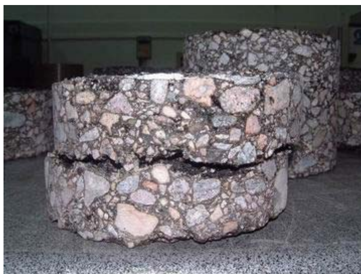
Rys. 3.14. Widok próbki po ścinaniu wewnątrzwarstwowym (warstwa wiążąca).
