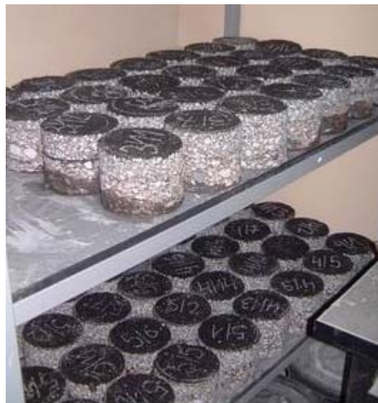
Rys.3.7. Widok płaszczyzn z oznaczonymi miejscami odwiertu i wyciętych próbek.
