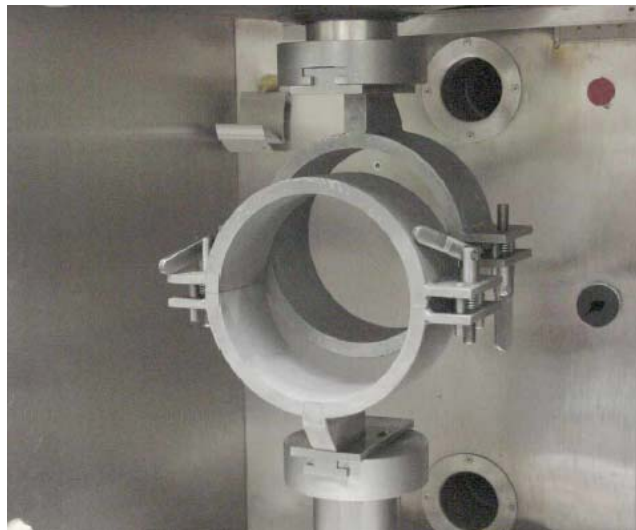
Rys. 2.5. Przyrząd do badania ścinania międzywarstwowego z USA [30].
