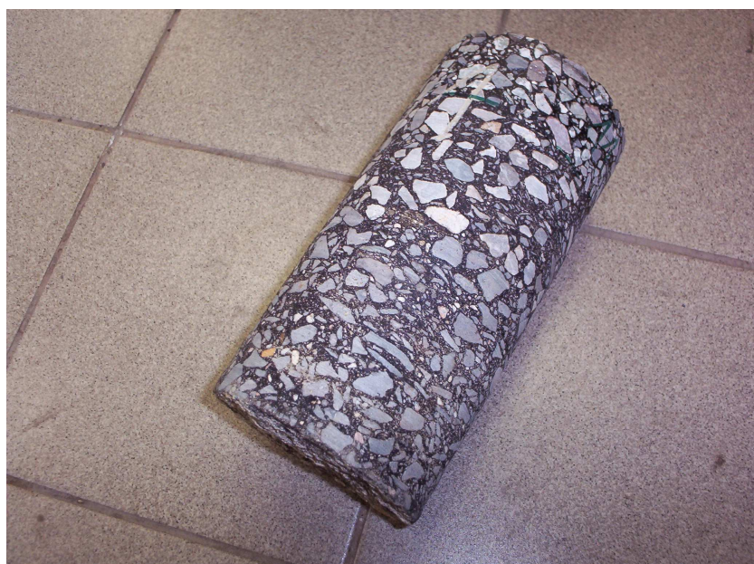
Rysunek 10 Widok warstw nawierzchni na próbce z odcinka doświadczalnego
