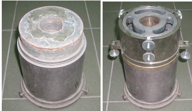
Rys. 3.18 Próbkę z pierścieniami obciążającymi i pierścieniem nasadczym
