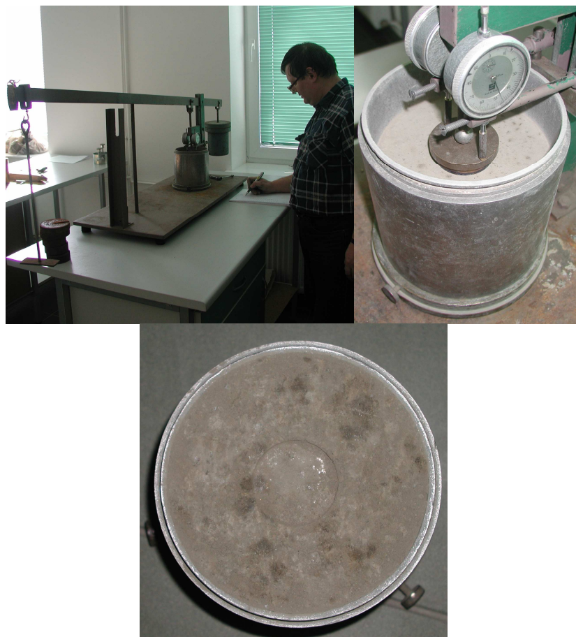
Rys. 8.5 Badanie nośności gruntu
