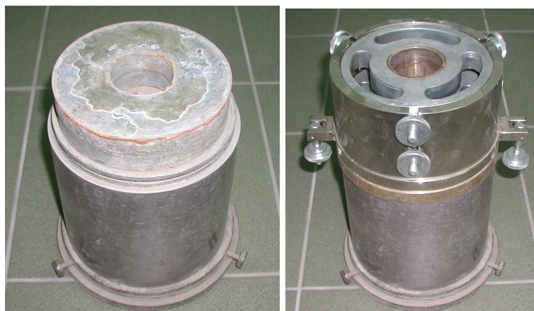
Rys. 10.4 Próbką z pierścieniami obciążającymi i pierścieniem nasadczym
