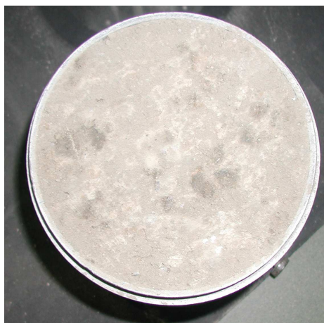
Rys. 3.17 Próbką do badań przygotowana w ubijaku Proctora
