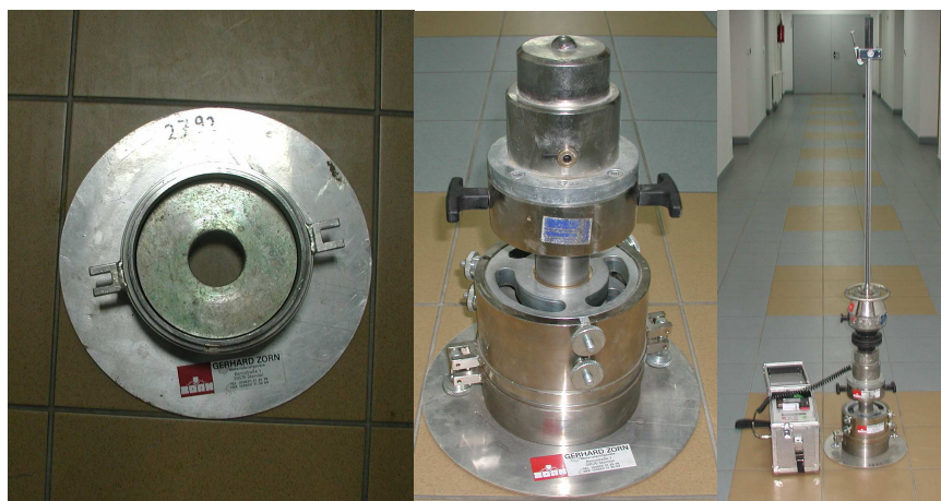
Rys. 3.16 Zestaw do badania CBR_d w warunkach terenowych
