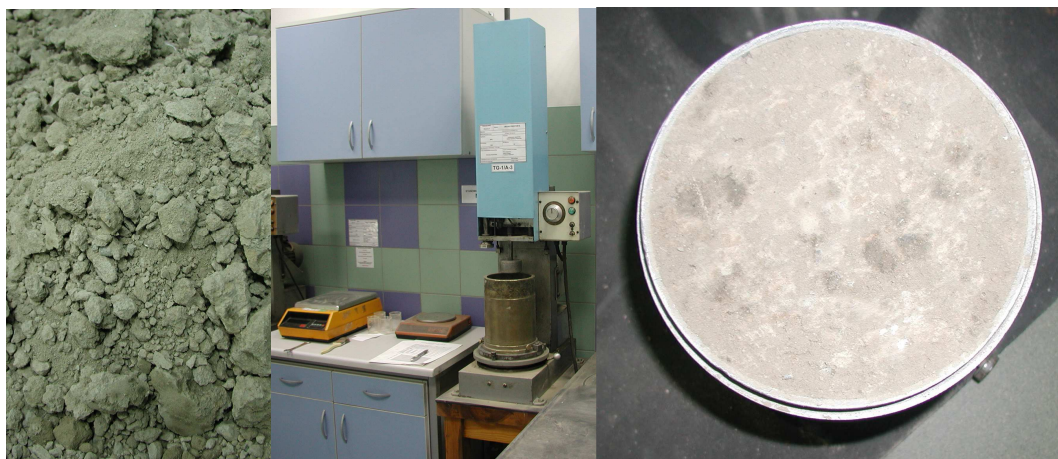
Rys. 8.3 Przygotowanie próbek gruntu w aparacie Proctora
