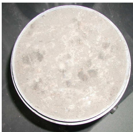
Rys. 10.2 Próbkę do badań przygotowana w ubijaku Proctora
