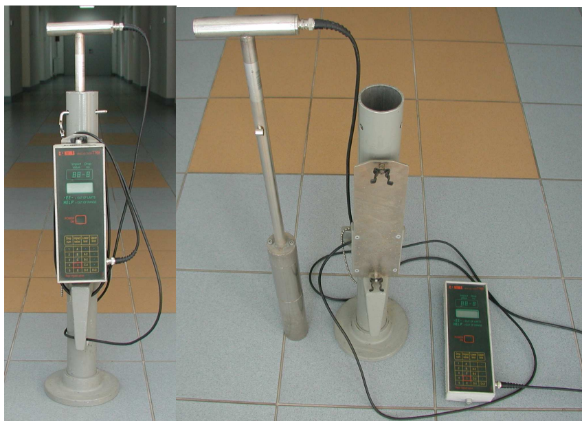
Rys 3.11 Połączone elementy testera Clegg'a gotowego do pracy
