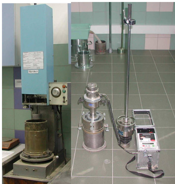
Rys. 3.15 Zestaw aparatury do badania dynamicznego wskaźnika \text{CBR}_d metodą laboratoryjną (od lewej ubijak Proctora, od prawej zestaw do badania \text{CBR}_d )
