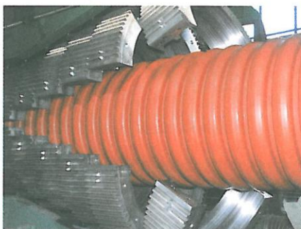
Rys. 2.1. Produkcja rur z tworzyw termoplastycznych: a) metodą wytłaczania; b) metodą nawijania.
