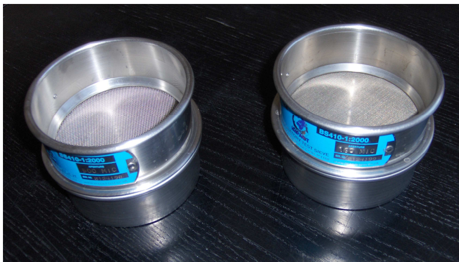
Rysunek 7 Komplet sit do oznaczania pozostałości emulsji asfaltowej na sicie
