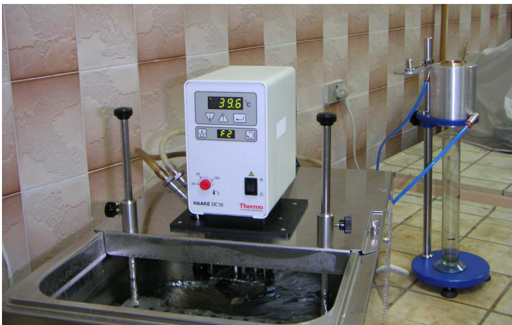
Rysunek 3 Przykładowy zestaw aparatury do oznaczania czasu wypływu
