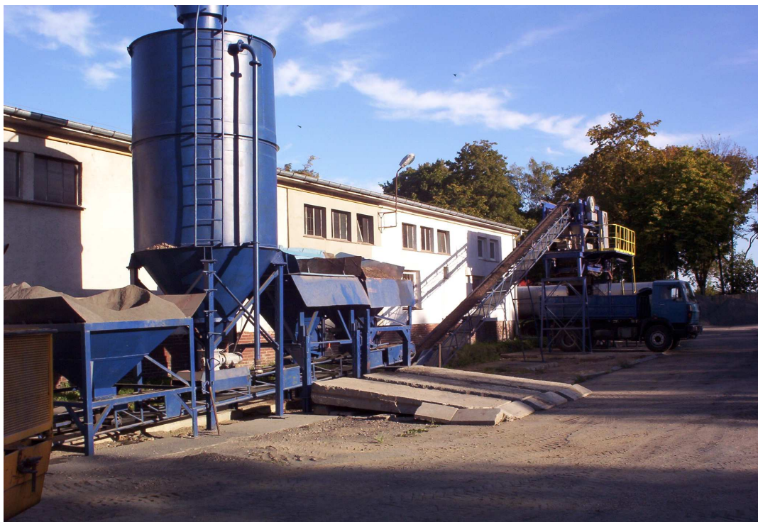
Rys. 6 Widok linii produkcyjnej mieszanki GE w bazie EMULEXU
