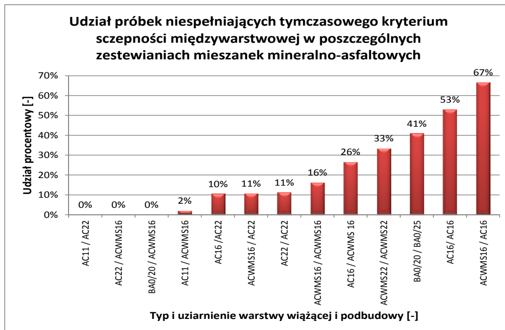
Rys. 3.16. Udział próbek niespełniających kryterium tymczasowego w poszczególnych zestawieniach mieszanek mineralno-asfaltowych przy połączeniu warstw wiążąca-podbudowa
