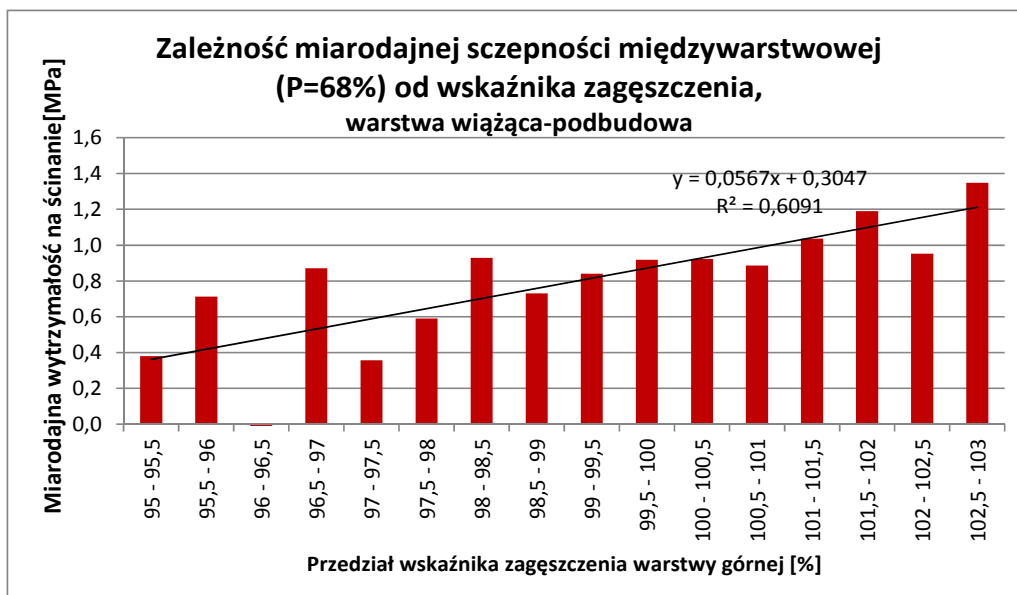
Rys. 3.24. Zestawienie miarodajnej szczepności międzywarstwowej połączenia wiążąca-podbudowa w zależności od wskaźnika górnej warstwy
