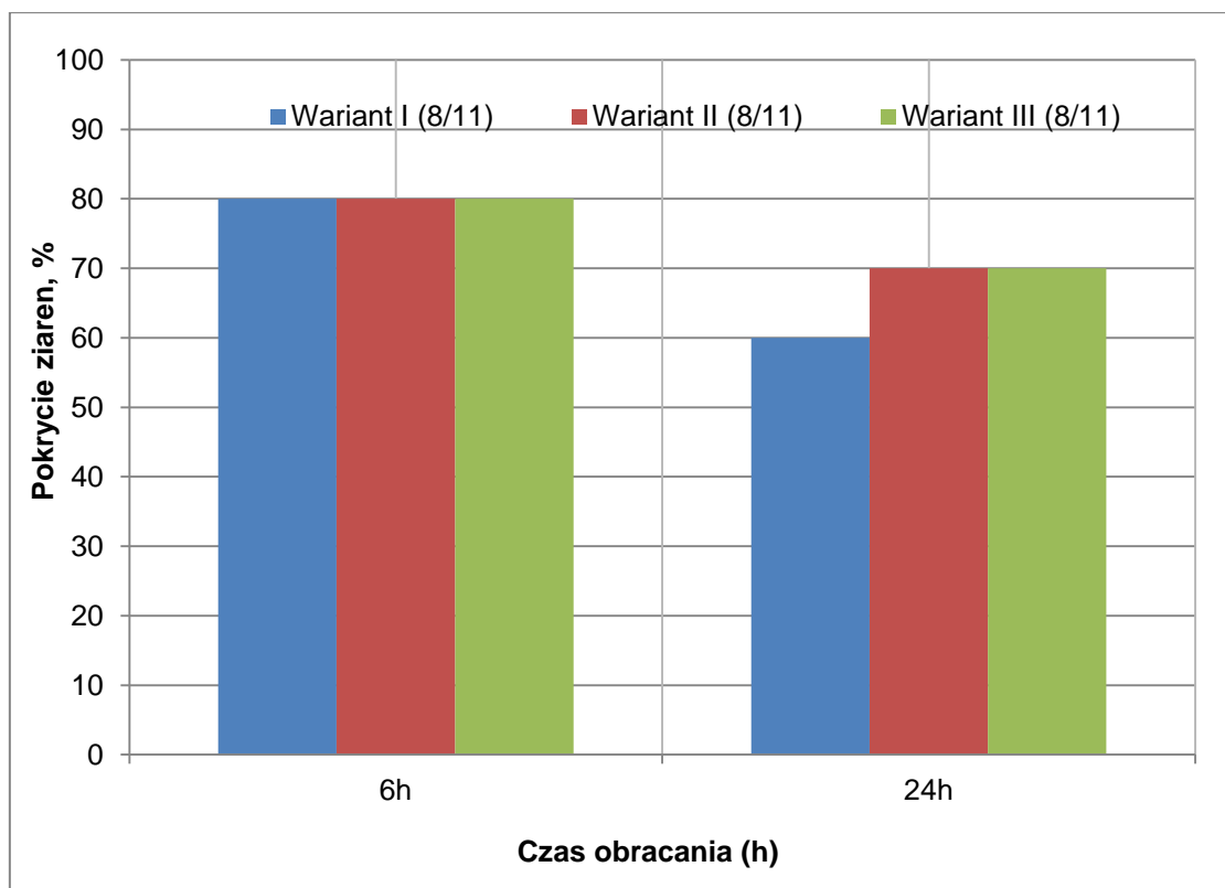
Rysunek 14 Przyczepność asfaltu do kruszywa (wartości średnie wg PN-EN 12697-11 zaokrąglone do 5%)
