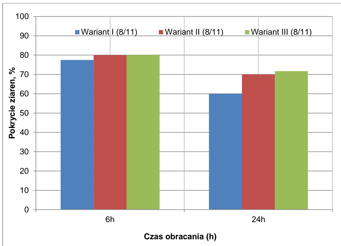
Rysunek 13 Przyczepność asfaltu do kruszywa (wartości średnie – bez zaokrąglenia)
