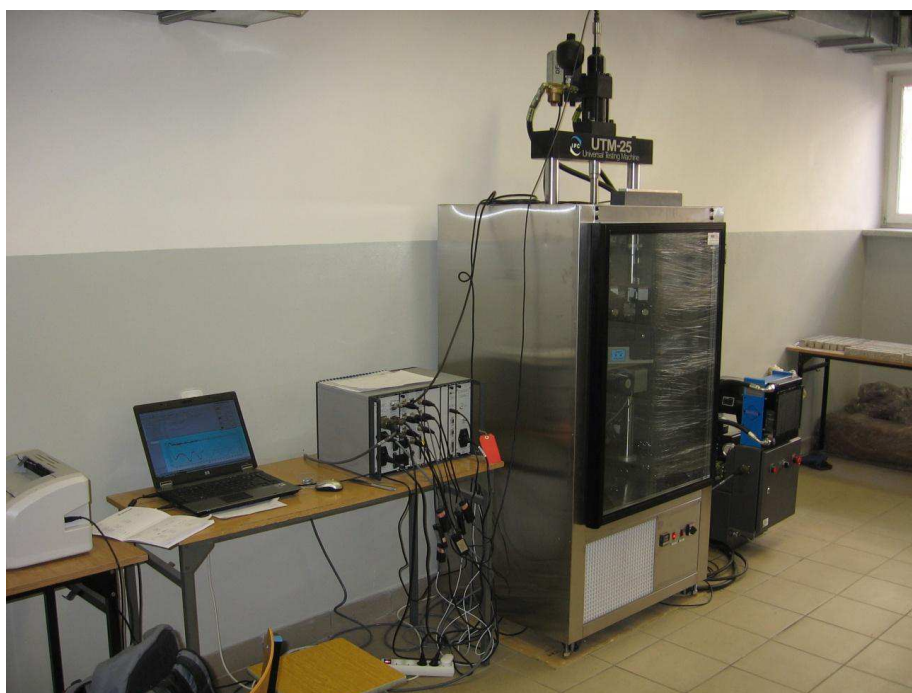
Rys. 6.8. Aparatura UTM-25 do badania trwałości zmęczeniowej
