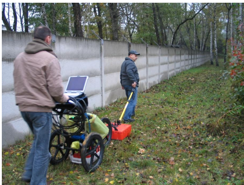
Rysunek 4.2 Pomiar z wykorzystaniem obu anten jednocześnie
