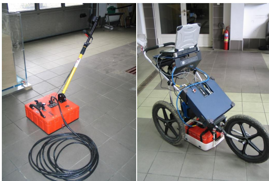
Rysunek 4.1 Anteny typu ground-coupled; z lewej antena o częstotliwości 270 MHz z zamontowaną rączką, z prawej antena o częstotliwości 400 MHz umieszczona na wózku wyposażonym w dystansomierz
