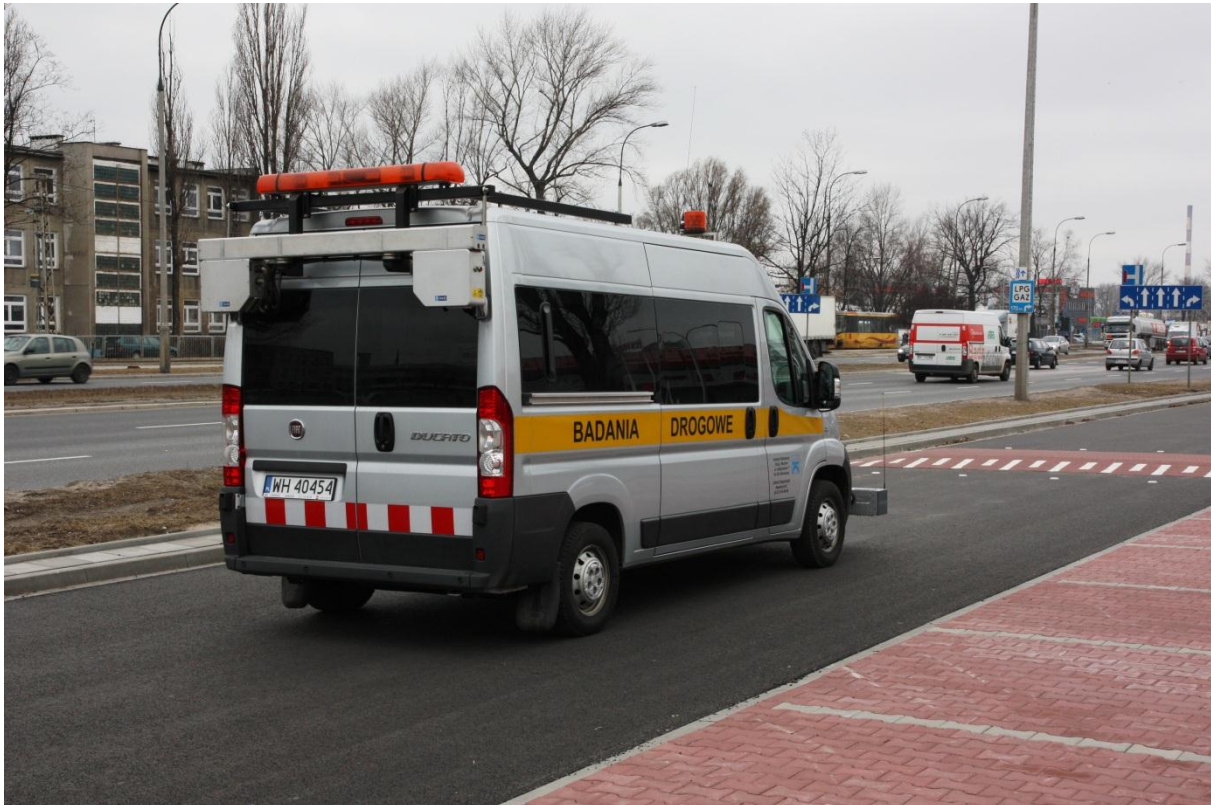
Rysunek 7: Wielofunkcyjny pojazd pomiarowy MFV
