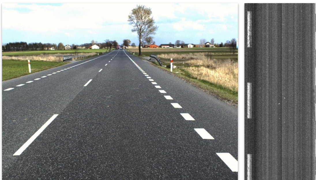
Rysunek 6: Przykład zdjęcia z kamery frontowej i ustandaryzowanego zdjęcia powierzchni
