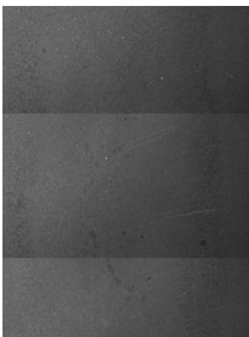
Rysunek 14: Zarysowania powierzchni (bez SSP)
