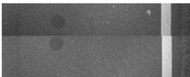
Rysunek 31: Przykład szczelnie załatanego miejsca po odwiercie – bez uszkodzeń
