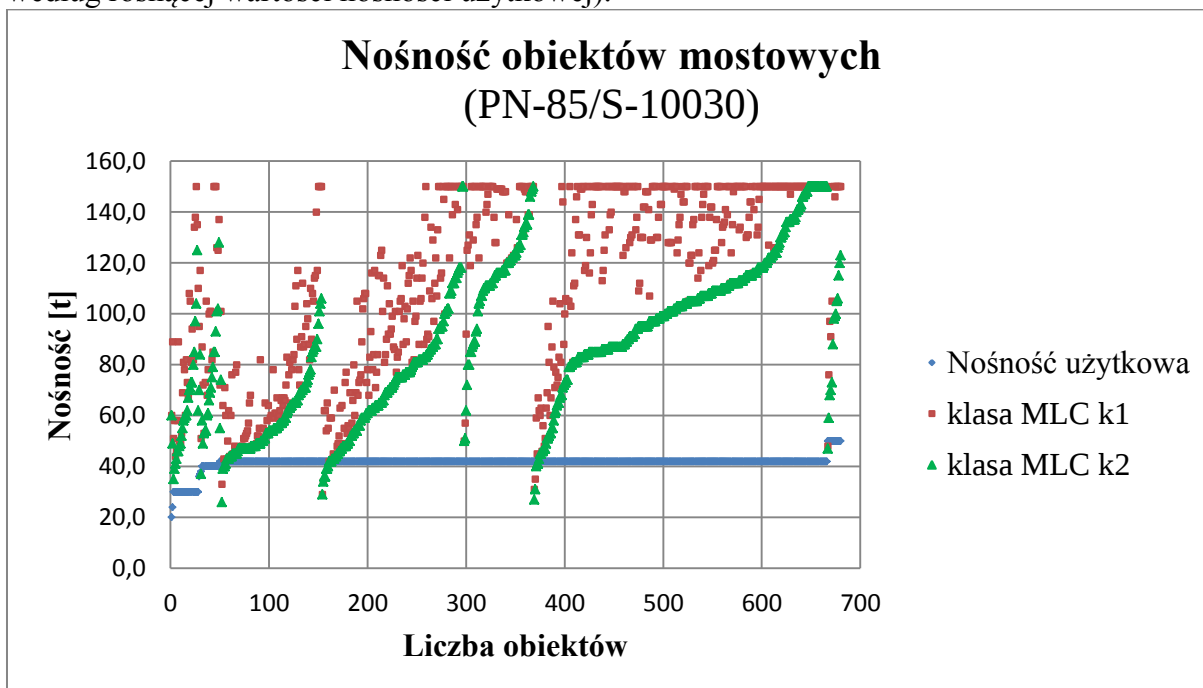
Rys. 5.5.3. Porównanie nośności użytkowej obiektów mostowych zaprojektowanych według PN-85/S-10030 z ich klasami MLC k1 i MLC k2
