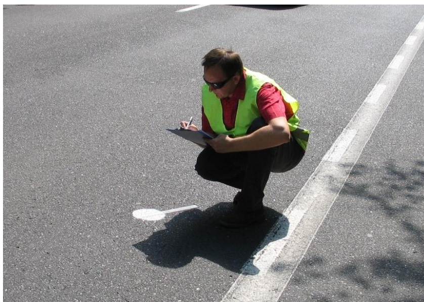
Rysunek 7 Badanie tekstury nawierzchni
