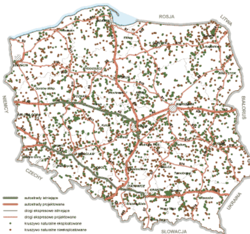
Rysunek 16 Rozmieszczenie złóż kruszywa naturalnych na tle infrastruktury dróg szybkiego ruchu i autostrad w Polsce
