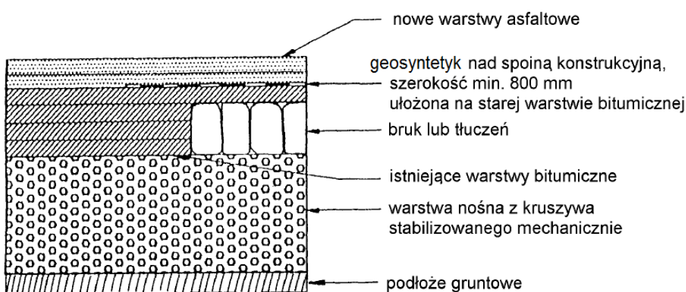
Rys 8 Wzmocnienie nawierzchni w strefie zmiany konstrukcji nawierzchni
