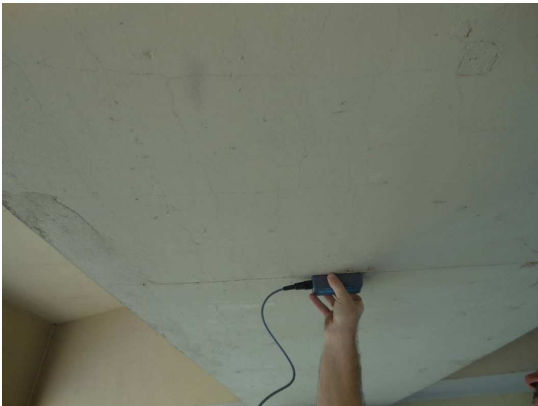
Fot. 46. Widok na spód dźwigara nr 2 w przęśle nr 6. Badanie położenia prętów zbrojeniowych, widoczna siatka zarysowań skurczowych.
