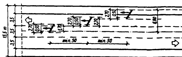
Rys. 4. Schemat pracy zespołu czterech pługów na drodze czteropasmowej dwukierunkowej
