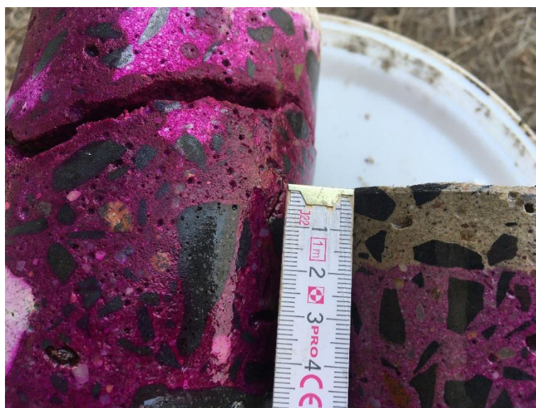
Fot. 2. Pomiar głębokości karbonatyzacji betonu – próbka III.
