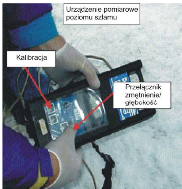
Zdjęcie 2 Pomiar poziomu osadu (szlamu) – wyświetlacz przykładowego mętnościomierza
