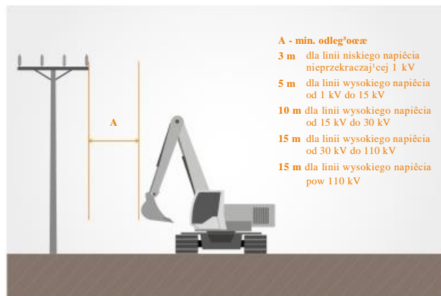
Rys. 6. Minimalna odległość prac od czynnej linii energetycznej w płaszczyźnie poziomej
