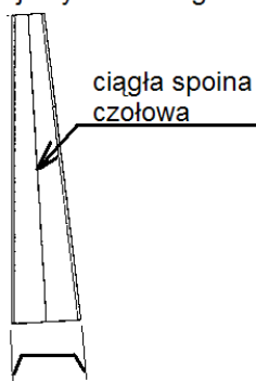
Rys. 8. Pale specjalne wykorzystywane do zniwelowania pochylenia ścianki
