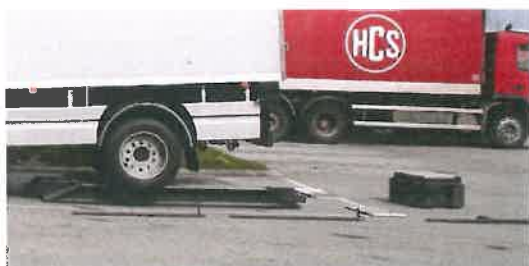
Rysunek A.4. Kalibracja TSD z usunięciem obciążenia (z lewej) oraz schemat kalibracji geometrycznej (z prawej)
