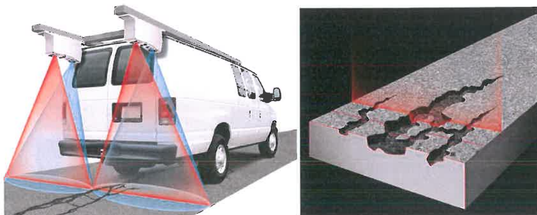
Rysunek A.12. Zestaw do pomiaru spękań nawierzchni oraz widok ogólnej zasady działania systemu
