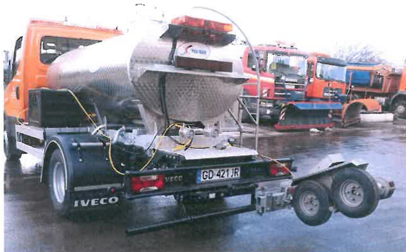
Fot. A.5. Samochód pomiarowy z zamontowanymi elementami składowymi systemu TWO
