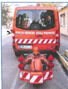
Fot. A.4. Zestaw pomiarowy i przyczepa pomiarowa SRT-3.
