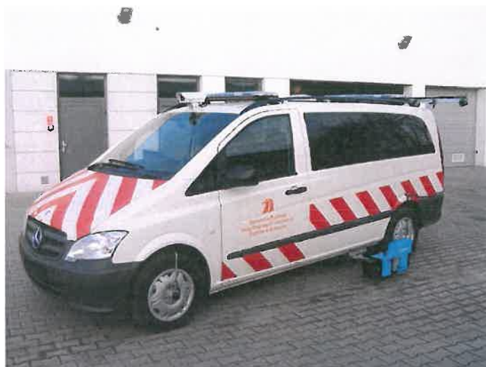
Fot. A.6. Samochód pomiarowy z zamontowanymi elementami składowymi systemu typu RMT 2.0.
