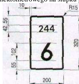
Rys. 3 Przykład tabliczki znaku ze znakiem kilometrowym i hektometrowym
