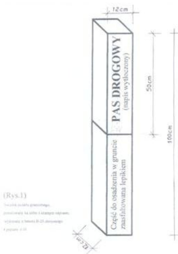
(Rys.1) Świadek punktu granicznego w części nadziemnej z każdej strony pomalowany na żółto farbą chlorokauczkową z czarnym napisem, wykonany z betonu C 20/25 zbrojonego 4 prętami Ø 10
