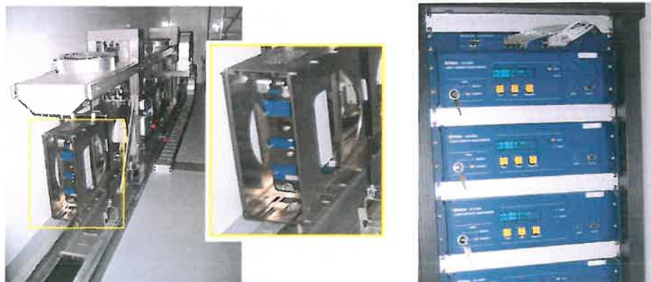
Fot. A.3. Belka pomiarowa z czujnikami laserowymi (po lewej), jednostka kontroli (z prawej)
