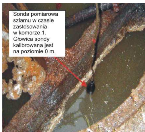
Zdjęcie 1 Pomiar poziomu osadu (szlamu) – kalibracja sondy
