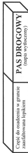
Rys. 1 Świadek punktu granicznego, pomalowany na żółto z czarnym napisem, wykonany z betonu C20/25 (B-25) zbrojonego 4 prętami \phi 10
