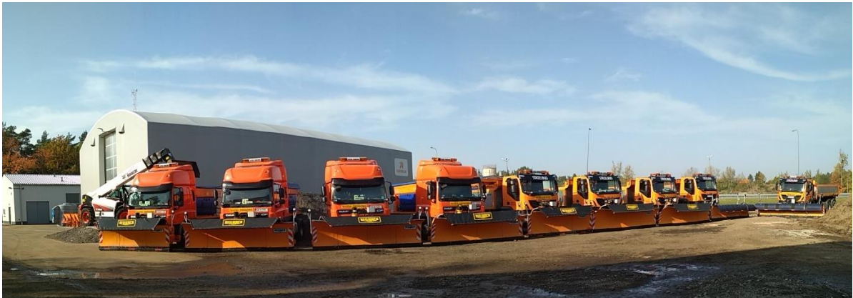
Fot. 3 Pojazdy przeznaczone do zimowego utrzymania dróg w Obwodzie Drogowym w Kobylnicy uzbrojone w pługi odśnieżne i solarki oraz zbiorniki na solankę.
